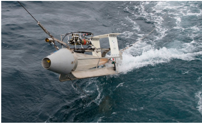
Figuur 4. Gulf VII planktonnet vlak nadat deze uit het water komt. Vooraan is de grijze conische neuskegel met net te zien. Midden op het frame zit de apparatuur om het zoutgehalte, de temperatuur en de diepte te meten. Aan het einde van het tuig zit een witte vleugel die zorgt voor stabiliteit.
