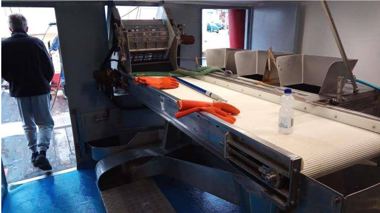
Figuur 3. De installatie voor het sorteren van de vangst, inclusief goot voor discards. Bron: Noor Visser, 2018
