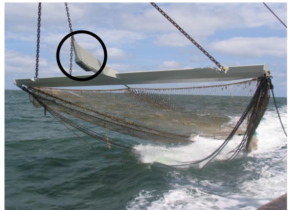
Figuur 3, Sumwing vistuig met regulier net ( HFK Engineering, 2009)
