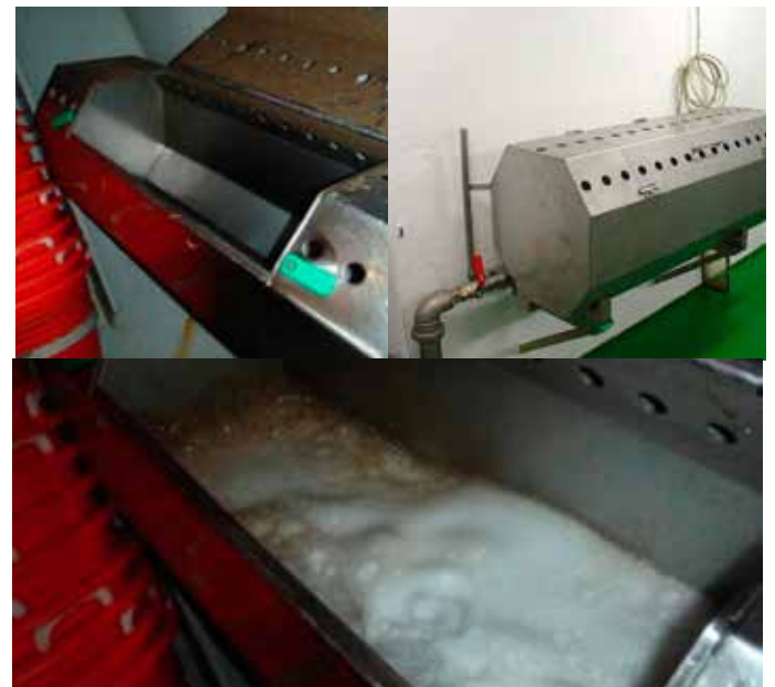
Figuur 3.6 - Wastrommel - bron: presentatie Roelof Van Urk, VCU Urk, 2012 - spoelinstallatie Nederlands langoustinevaartuig
